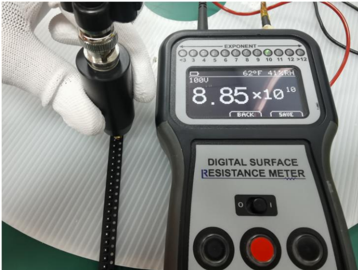
图 6-1. 样品 4# 载带表面电阻测试 Figure 6-1. Carrier Tape Resistivity Measurement
