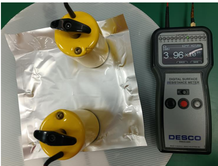
图 6-3. 样品 4# MBB 表面电阻测试 Figure 6-3. MBB Resistivity Measurement
