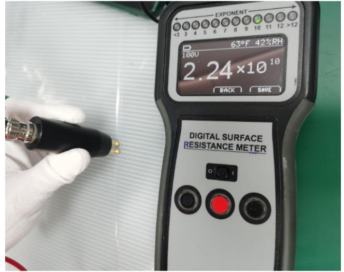
图 6-2. 样品 4# 盖带表面电阻测试 Figure 6-2. Cover Tape Resistivity Measurement
