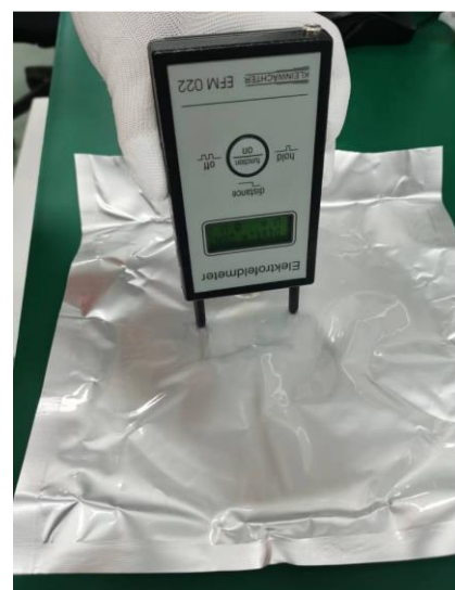
图 6-4. 样品 4# MBB 摩擦电压测试 Figure 6-4. MBB Voltage Test
